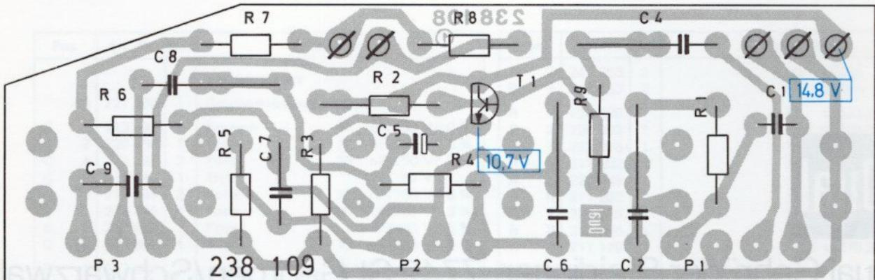
Fig. 4 IC-Endverstärker 239 883 Bestückungsseite
