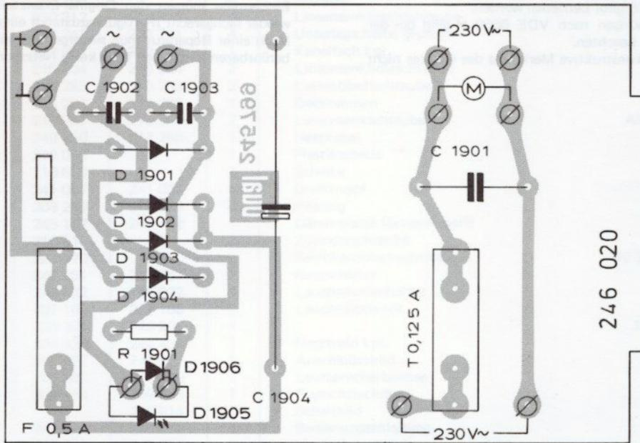
Fig. 3 Regelverstärker 221 100 Bestückungsseite
