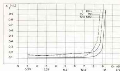
Klirrfaktor bei 40 Hz, 1000 Hz, 12500 Hz
