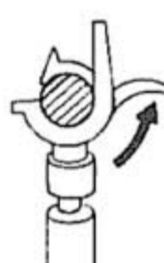
Den Tonarm auf die Tonarmauflage zurückführen und mit der Sicherheitsklemme arretieren.
